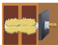
سازه آجری حفره دار
